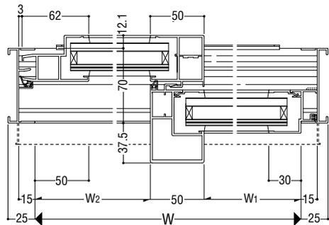
※たて枠の破線部は、耐風圧性S-7(3600Pa)の場合を示す。
